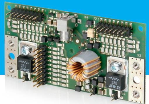
Die Abgleichplatine ID MAT-B/-S ist eine manuell einstellbare Anpassungsschaltung zum Aufbau kundenspezifischer Single-Antennen mit einer Betriebsfrequenz von 13,56 MHz und der Eingangsimpedanz von  $50\Omega$ .
